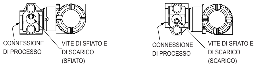
Figura 27 - Montaggio orizzontale - Sfiato e scarico della cavità
