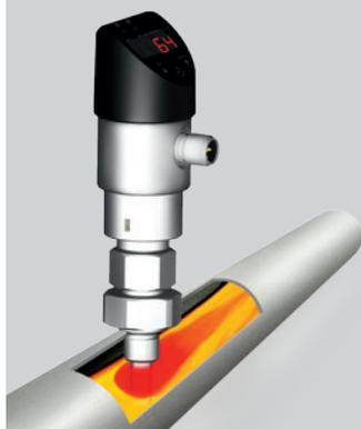
Il sensore dell'FSD-3 viene riscaldato ad una temperatura di alcuni gradi Celsius superiore rispetto al fluido circostante. Quando un fluido fluisce lungo la sonda viene continuamente estratto calore per raffreddarla. La dissipazione di calore è direttamente proporzionale alla portata. Pertanto, più aumenta la rimozione di calore, più velocemente scorre il fluido. Al contrario, ciò significa che se non viene estratto calore non avviene flusso del fluido.
